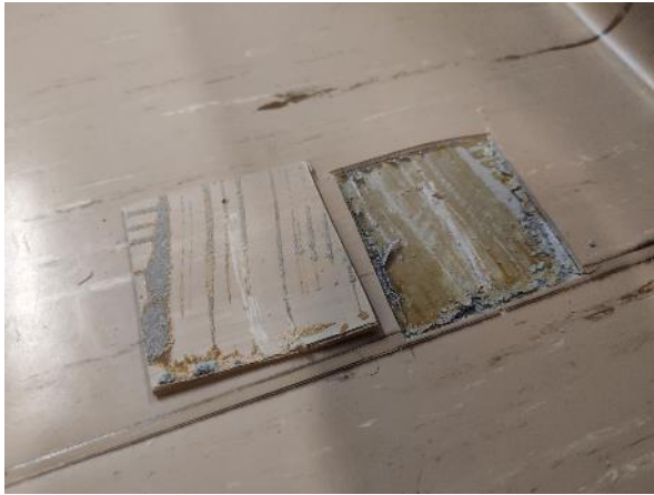
Kuva 23: Tilan 1088 muovimattonäytteessä MNVO1 havaittiin poikkeavana pitoisuutena 2-etyyli-1-heksanolia, joka viittaa lievään vaurioon muovimatossa.
